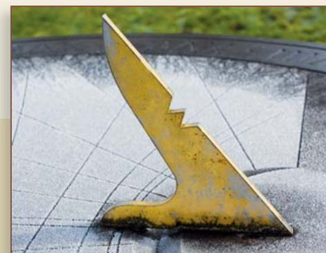
**Ancienne photo qui montre le détail du style disparu du cadran 2.** On y remarque très bien les encoches qui délimitent un triangle indiquant la date (lorsque l'ombre de la pointe du triangle se projette sur une des lignes courbes il est la date en question).
